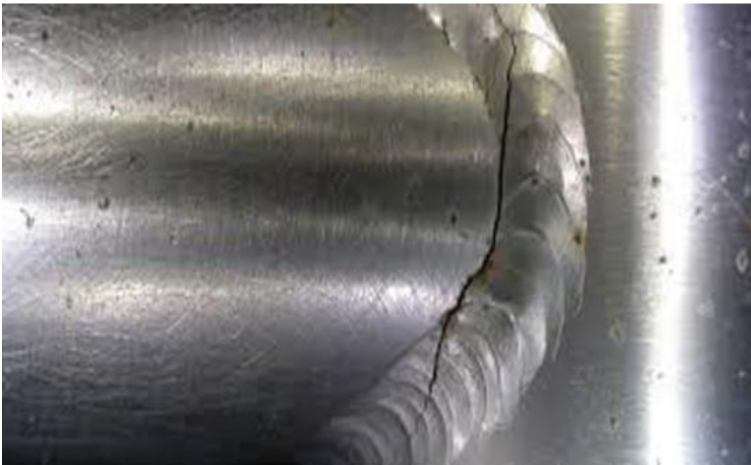
Slika 7.16. Pukotina u zavaru [8]
