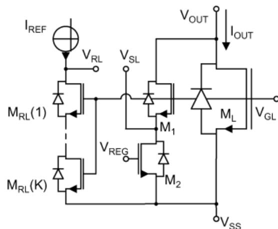
Slika 3.9 Korištenje replika MOSFETA snage za mjerjenje struje
