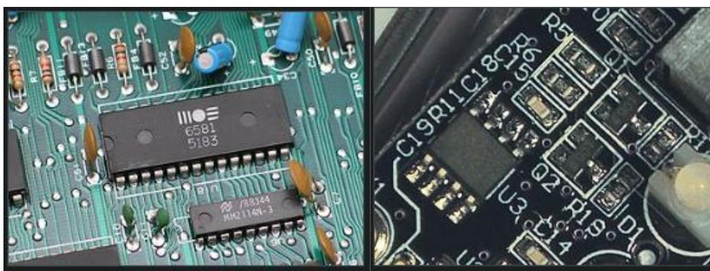
*Slika 4.2 Tiskane pločice s THT i SMD komponentama*
