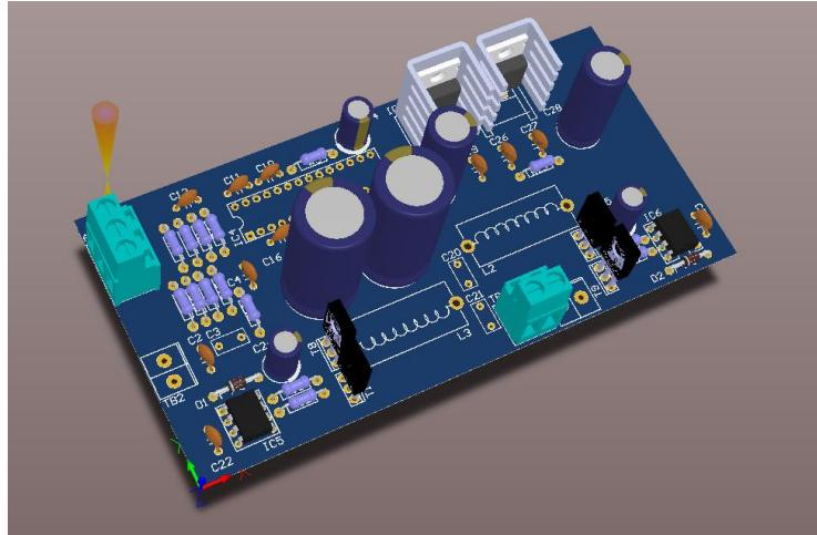
*Slika 5.10 Izgled tiskane pločice audio pojačala*
