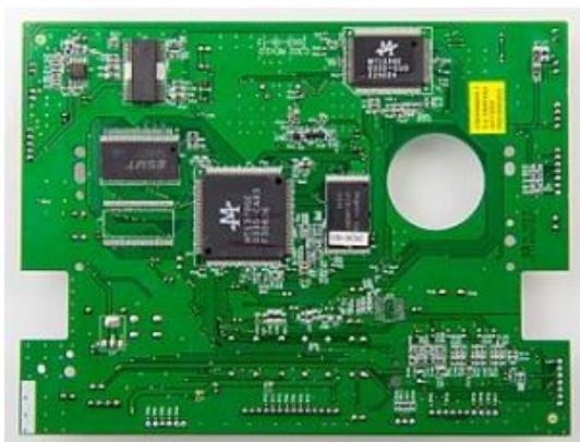
Slika 4.1 Tiskana pločica sa SMD komponentama
