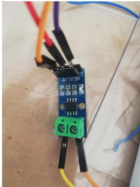
*Slika 5.9 Senzor struje ACS712*
