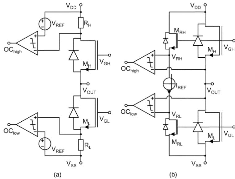
Slika 3.8 Strujni ograničivač na mostu pojačala
