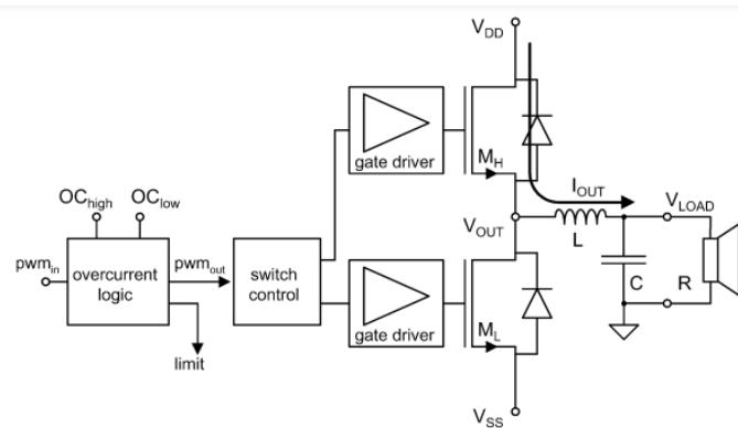
Slika 3.10 Shema pojačala klase D sa strujnim ograničivačem
