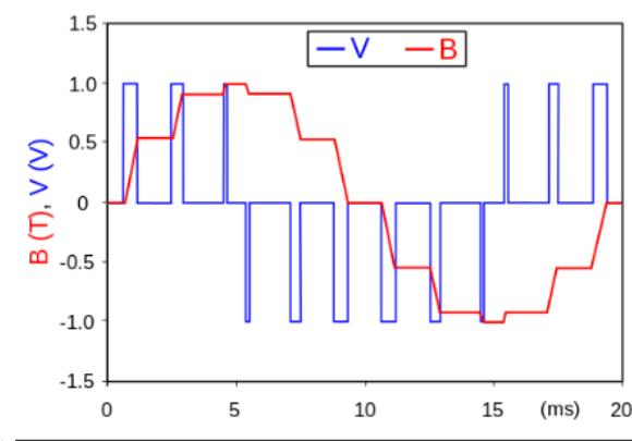
Slika 2.6 Signal dobiven modulacijom širine impulsa (PWM)
