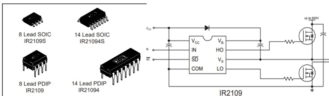
Slika 2.12 Izgled i shema upravljačkih jedinica MOSFETa
