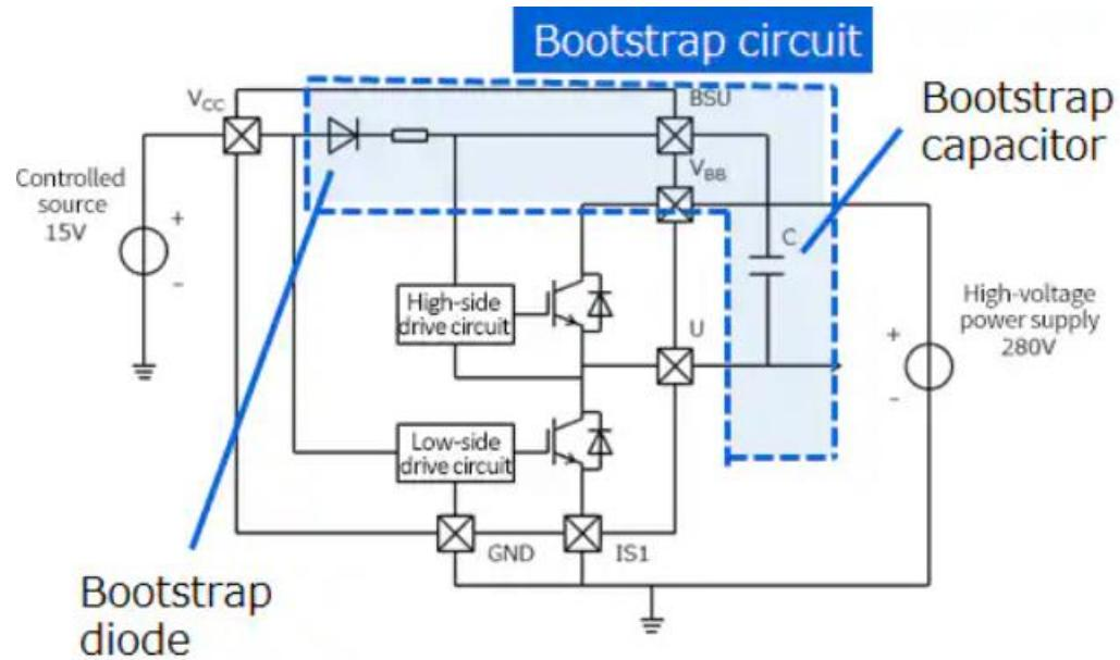
Slika 2.13 Bootstrap kondenzator u mosnom spoju MOSFETA
