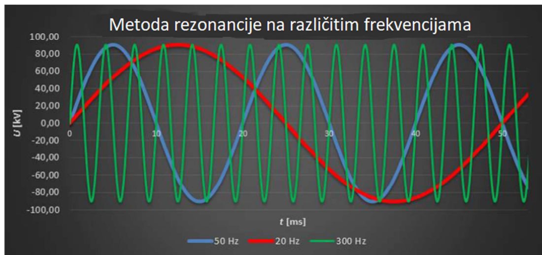
Slika 5.5: Demonstracija upotrebe oblika napona za izvođenje ispitivanja napona prema metodi rezonancije i ovisnosti [5]
