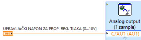
Slika 5.25. Port za generiranje upravljačkog napona proporcionalnog regulatora tlaka
