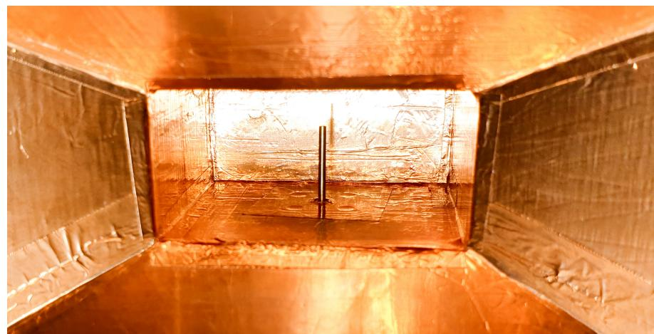
Slika 4.16 Proizvedena pobudna sonda u lijevak anteni.
