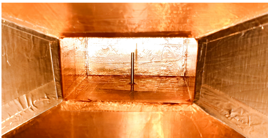
Slika 4.16 Proizvedena pobudna sonda u lijevak anteni.
