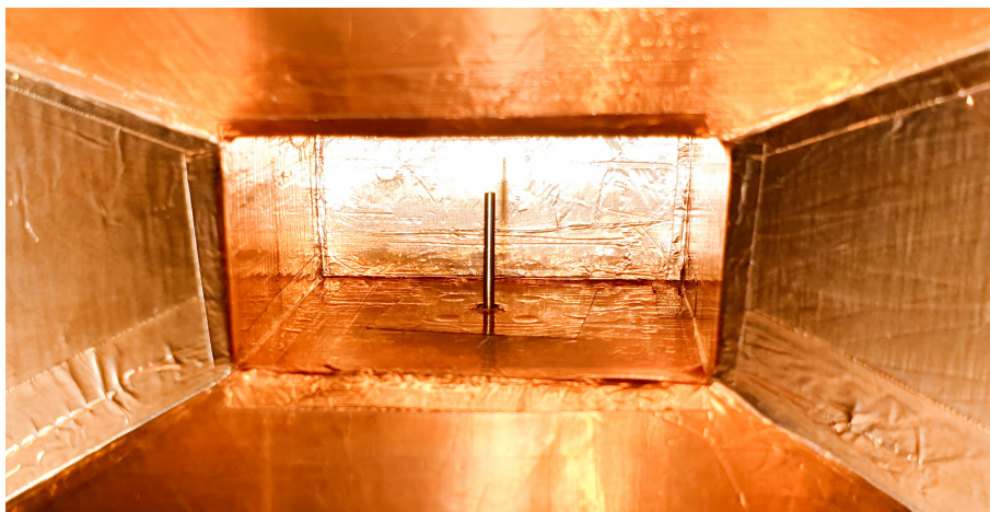
Slika 4.16 Proizvedena pobudna sonda u lijevak anteni.
