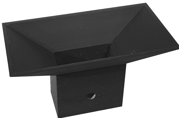
Slika 4.14 Lijevak antena proizvedena na 3D pisaču Original Prusa MINI+ .
