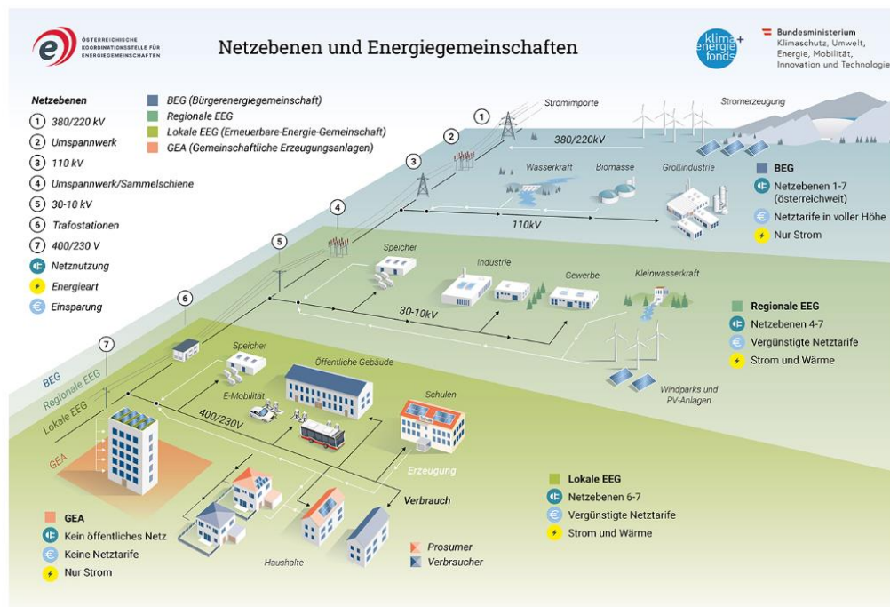
Slika 8. Naponske razine i energetske zajednice u Austriji [8]
