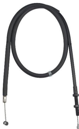
Slika 3.5. Sajla za mehaničko uključivanje spojke [10]
