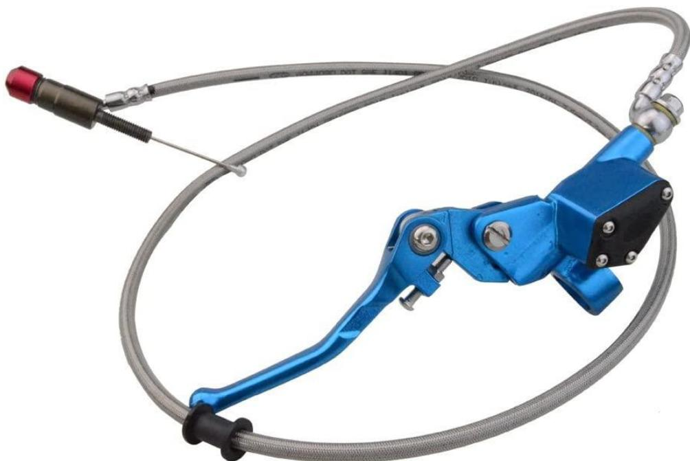
*Slika 3.6. Sustav sa hidrauličkom aktivacijom spojke [12]*
