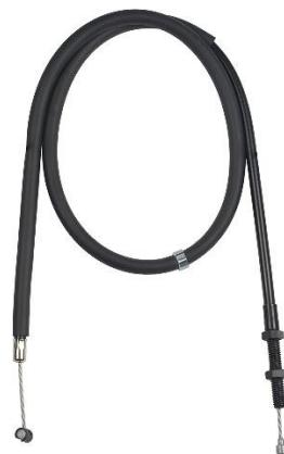
*Slika 3.5. Sajla za mehaničko uključivanje spojke [10]*
