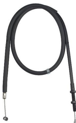
Slika 3.5. Sajla za mehaničko uključivanje spojke [10]
