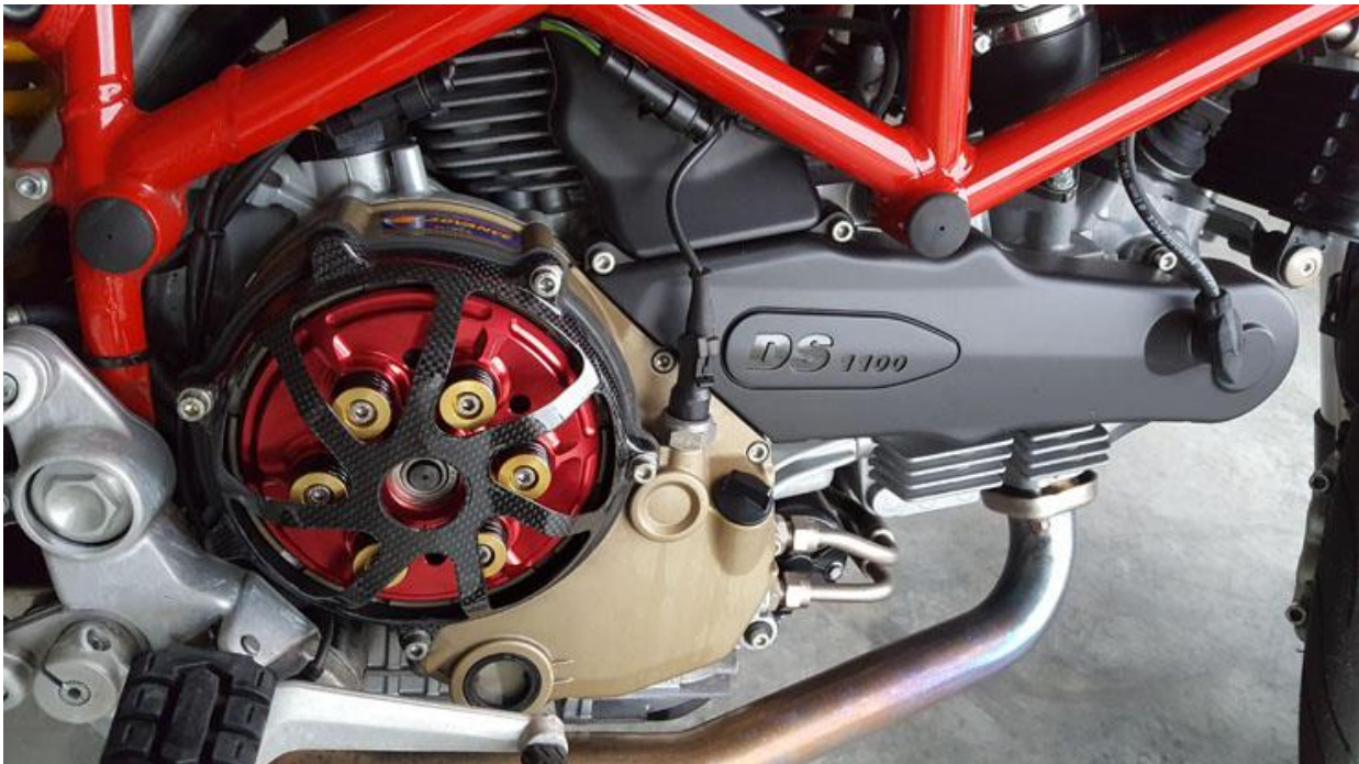
Slika 3.7. Izvedba suhe spojke [15]
