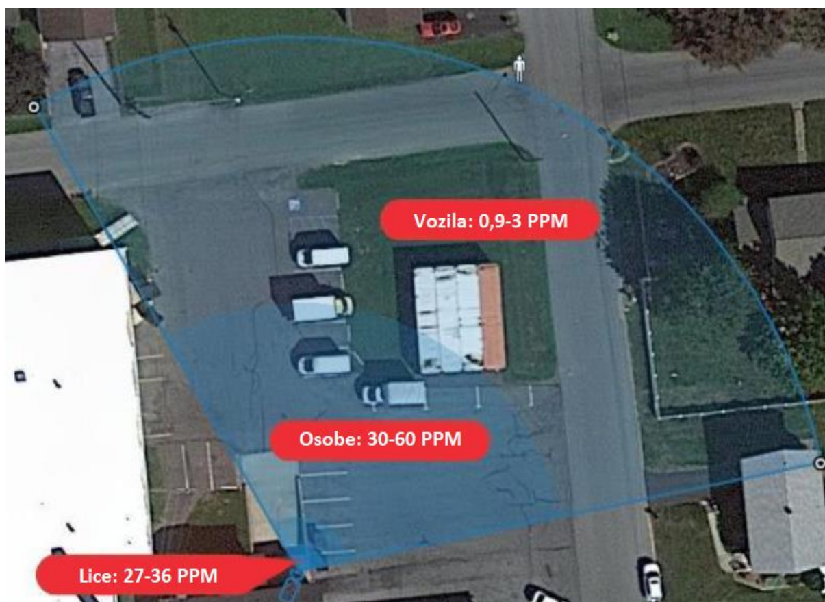
Slika 5.3. Detekcija objekta ovisno o širini scene [66]
