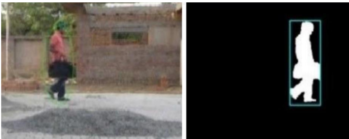
Slika 5.13. Tehnika uklanjanja pozadine slike [82]
