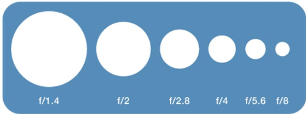
Slika 4.10. Ovisnost f-broja o otvoru aperture [16]
