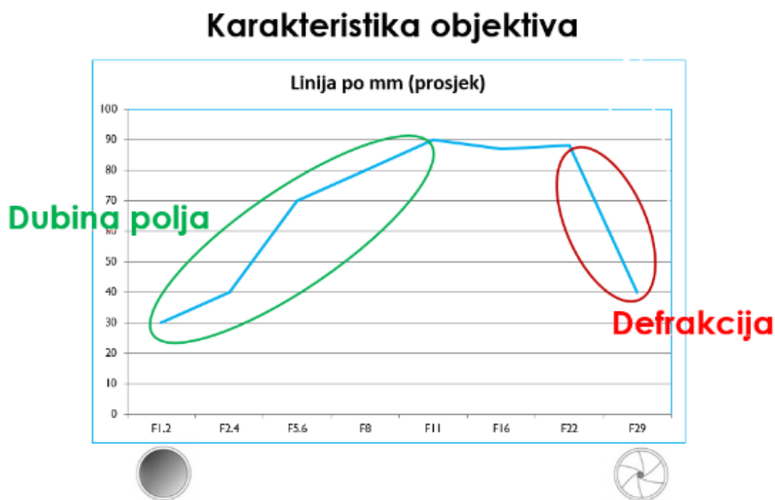
Slika 4.13. Karakteristike leće objektiva [21]
