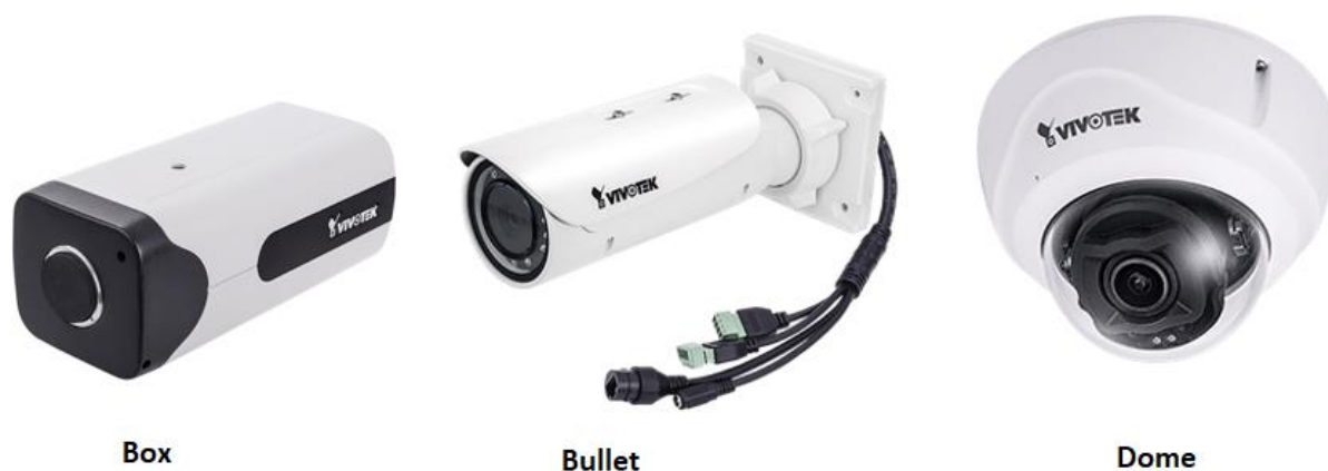
Slika 4.23. Vrste IP kamera [33]
