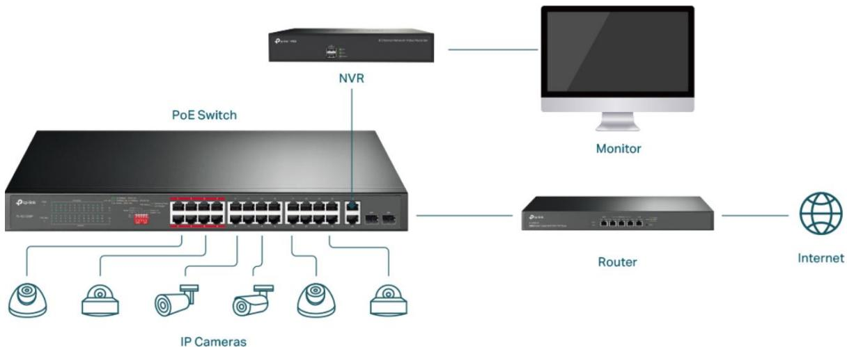
*Slika 4.38. Mrežni preklopnik u sustavu videonadzora [57]*
