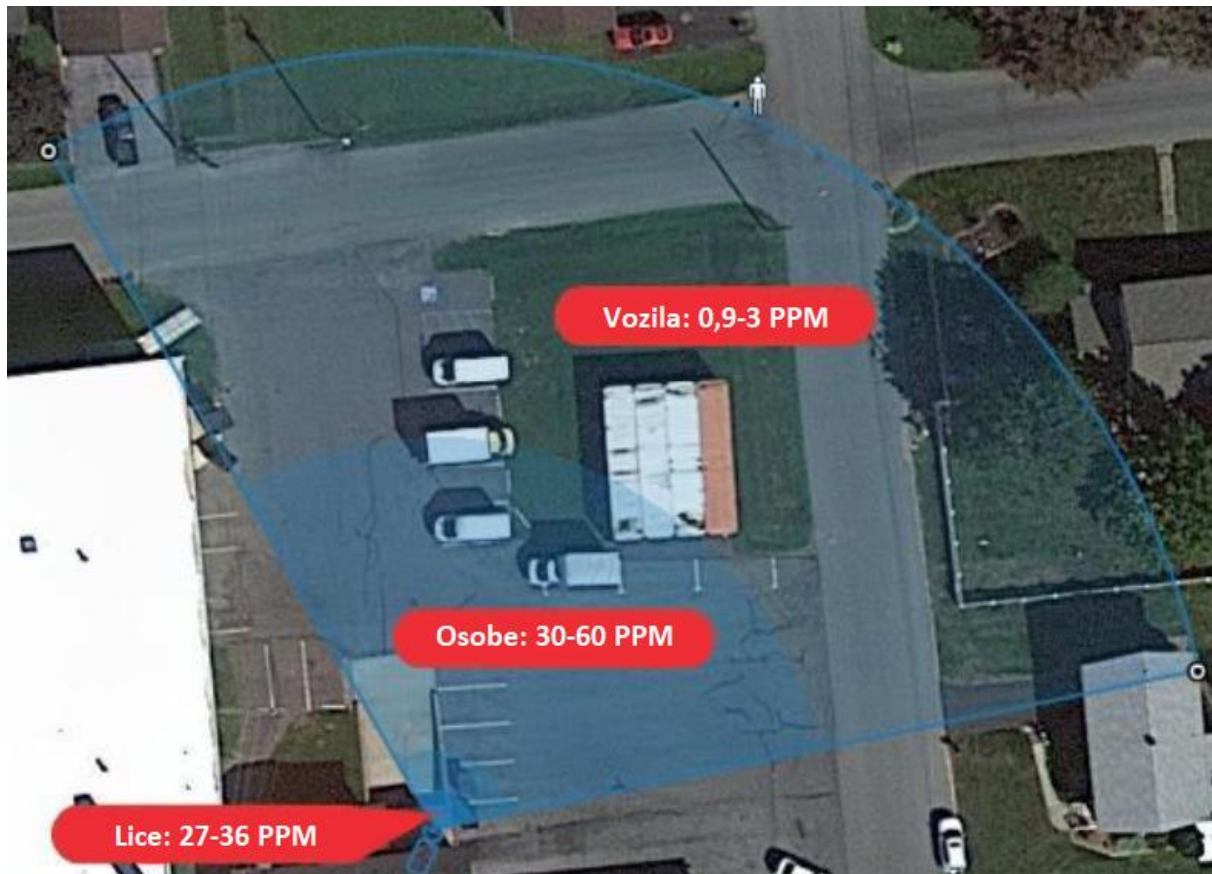
Slika 5.3. Detekcija objekta ovisno o širini scene [66]
