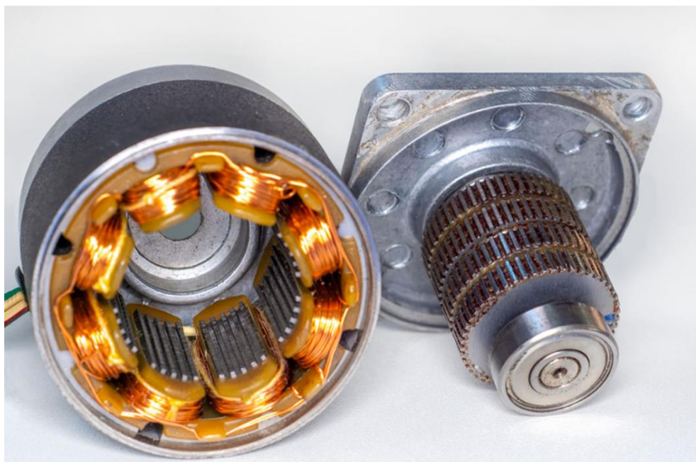
Slika 8.2. Rotor zubčanika okružen magnetskim zavojnicama/ Koračni motor [12]
