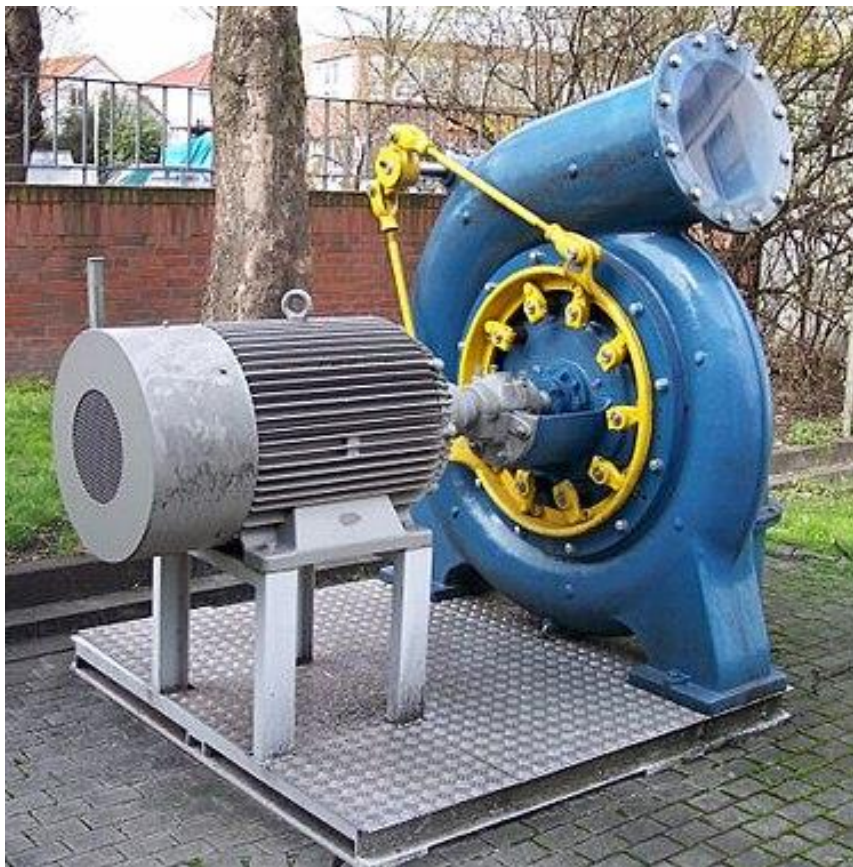
Slika 3.6. Mala Francisova turbina spojena na generator [30]
