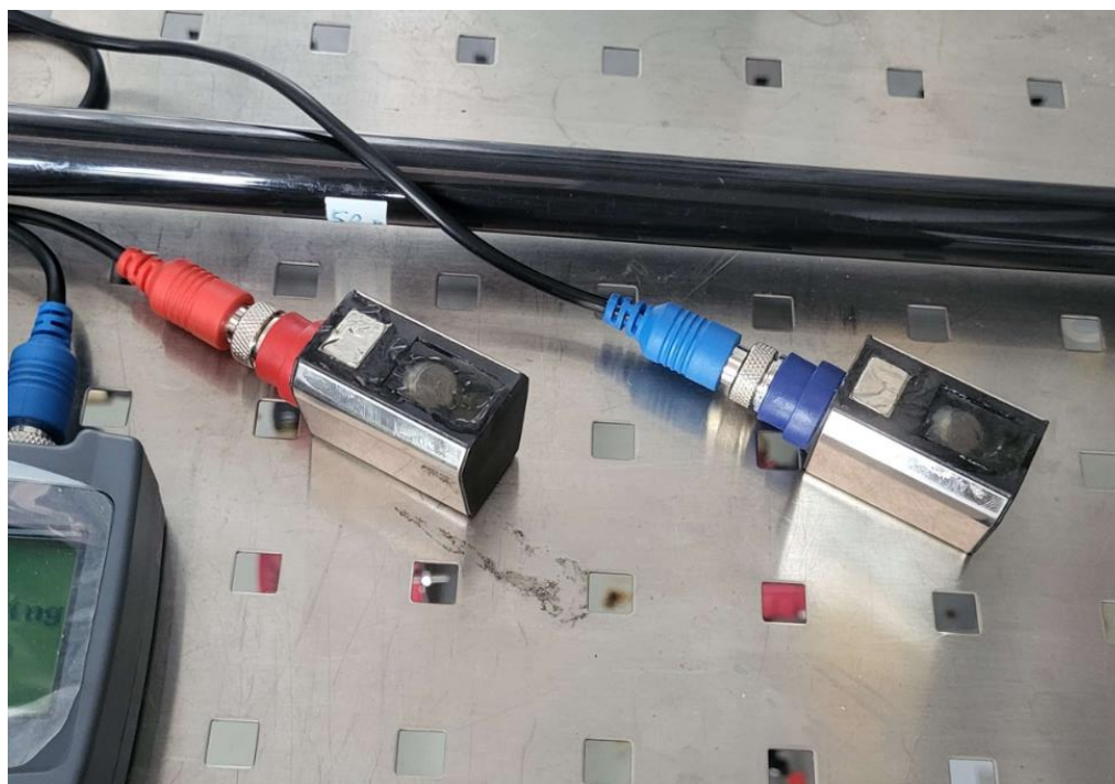
Slika 7.3. Naneseni gel na pretvaračima (izvor: autor)
