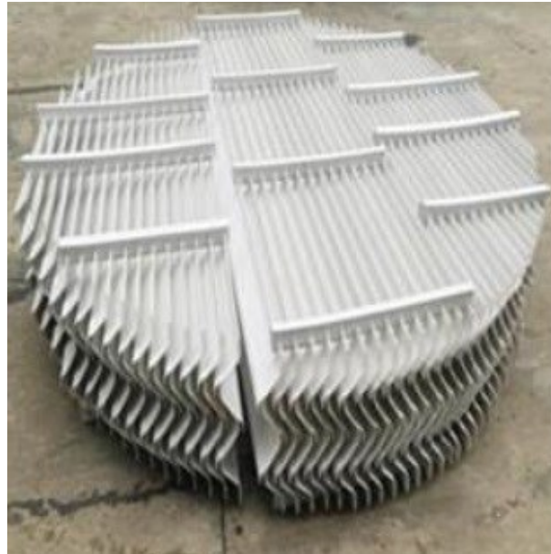
Slika 3.3. Prikaz eliminатора kapljica [4]
