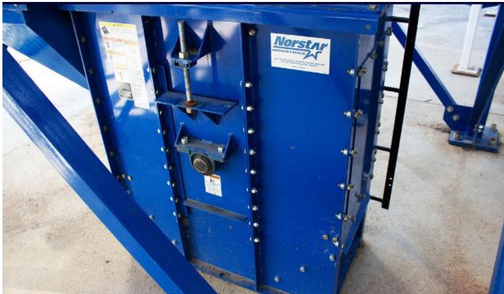
Slika 3.4. Primjer zateznog uređaja s vijkom kao zateznim elementom tvrtke „Norstar“ [6]
