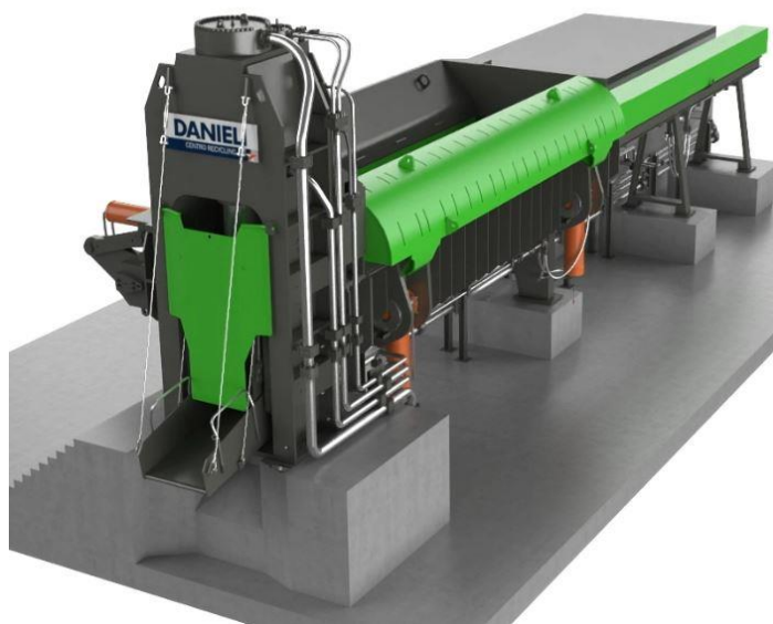
Slika 20 Stroj za rezanje i kompresiju metalnog otpada
