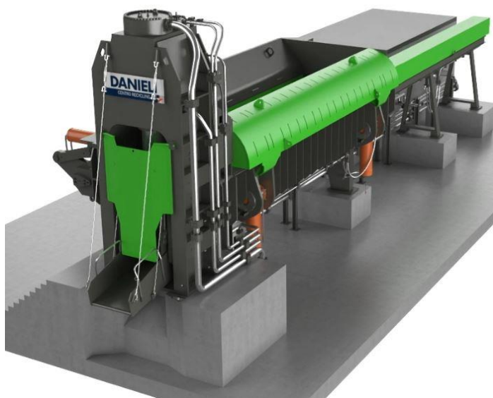
Slika 20 Stroj za rezanje i kompresiju metalnog otpada
