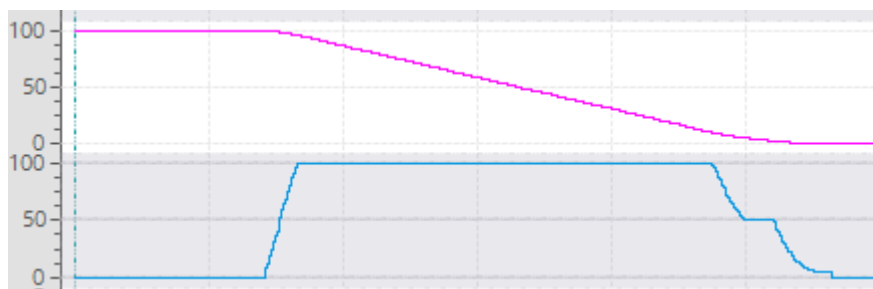
Slika 25 Prikaz reference ventila i gibanja cilindra pri različitim točkama usporavanja (gornja krivulja predstavlja poziciju cilindra, donja referentnu vrijednost otvorenosti ventila) 1/3
