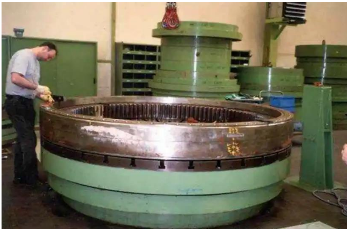
Slika 2.3. Upravljački prsten za azipod od 7.5 MW [4]
