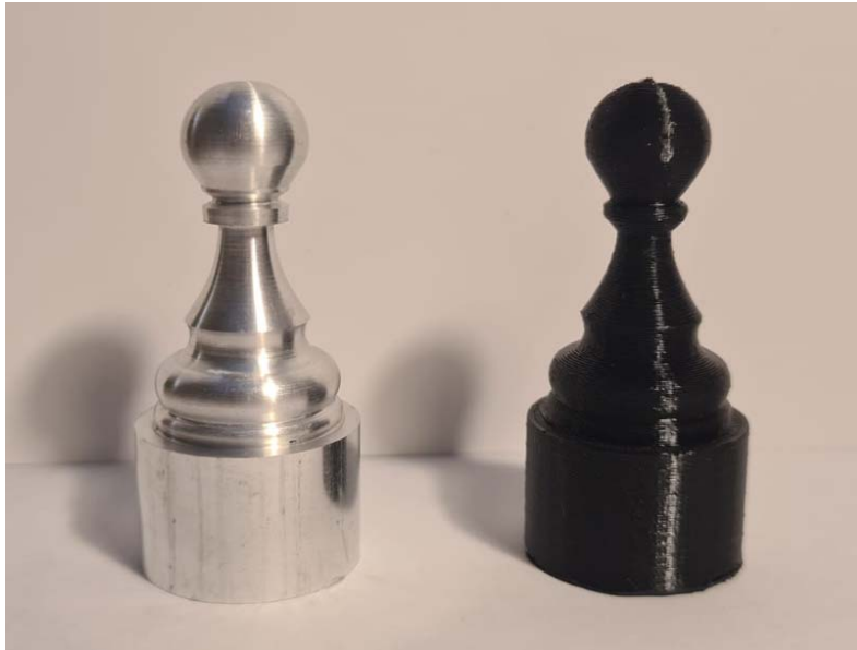
Slika 6.16 Tokarena i tiskana figurica jedna pored druge
