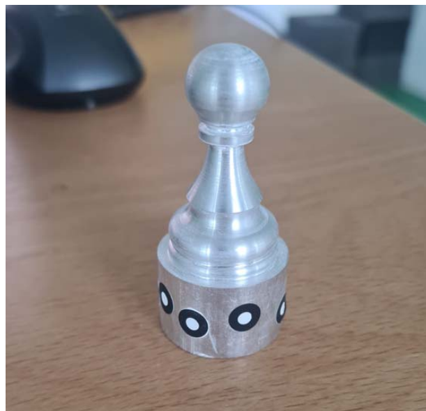
Slika 5.6 Pravilno postavljen niz referentnih točaka
