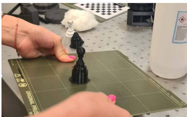
Slika 6.13 Postupak savijanja podloge za uklanjanje artefakta
