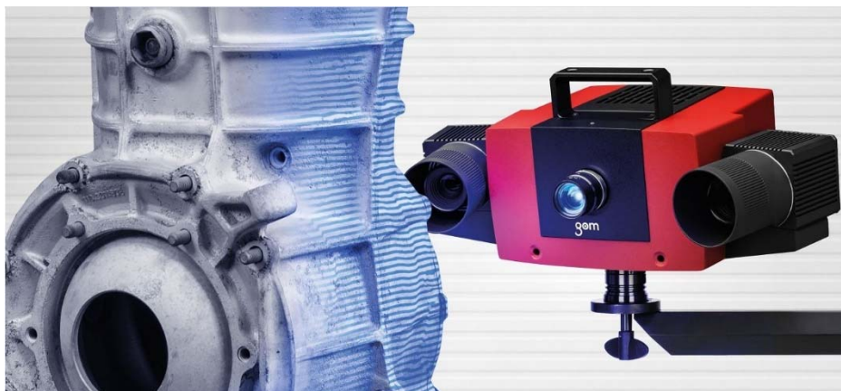
Slika 4.17 Projekcija linija ATOS skenerom na objekt
