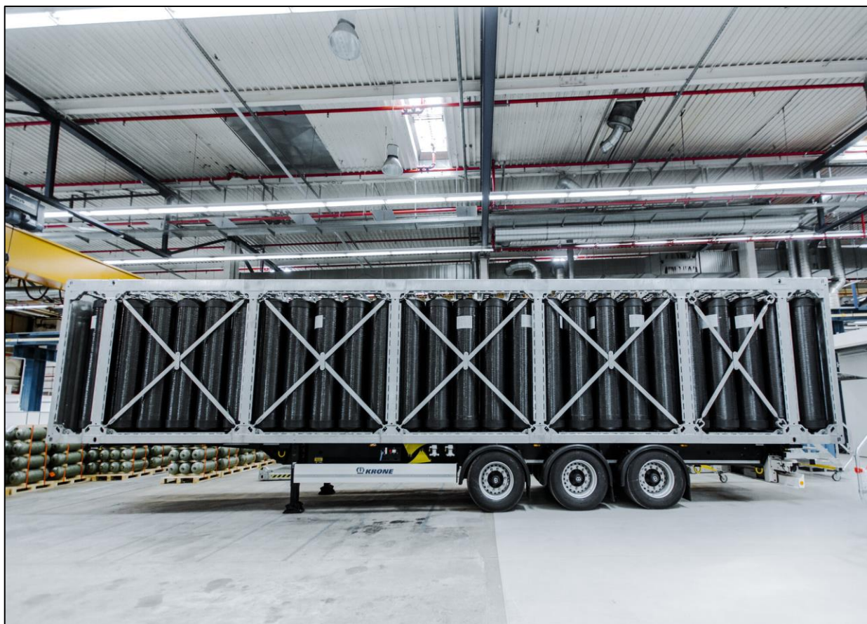
Slika 26. Prikaz transporta stlačenog zraka [51]
