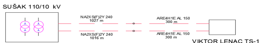
Slika 2.2. Blok shema napajanja Brodogradilišta Viktor Lenac[10]
