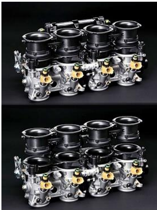
Slika 3.5. Usisni sustav s trubicama promjenjive duljine [10]
