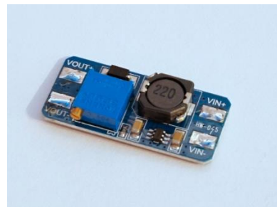
Slika 4.3. Izgled uzlaznog pretvarača MT3608
