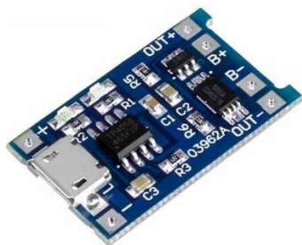
Slika 4.2. Izgled modula TP4056
