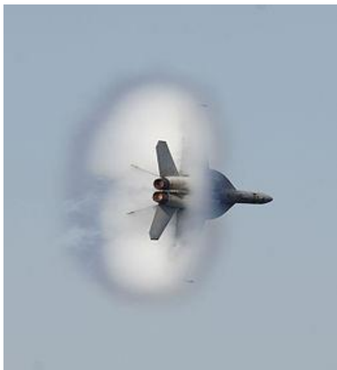
Slika 2.2 : Prikaz probijanja zvučnog zida [10]
