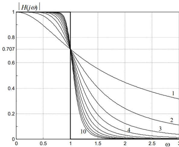
Slika 2.3. Amplitudno frekvenčske karakteristike Butterworthovih aproksimacija [2]
