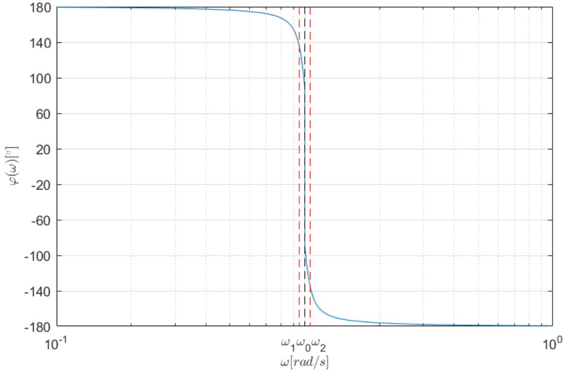
Slika 3.4. Grafički prikaz fazno frekvencijske karakteristike  $\varphi(\omega)$
