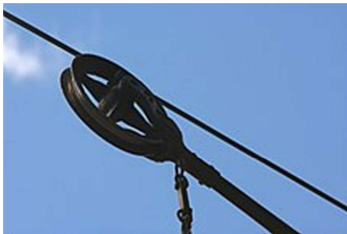
Slika 3.4. Primjer kontaktnog kotača na oduzimaču struje.
