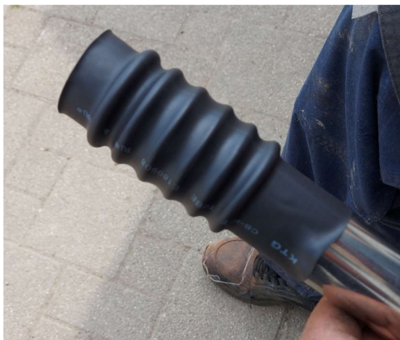
Slika 2.5. Termo-deformabilna polimerna cijev na kalupu nakon zagrijavanja
