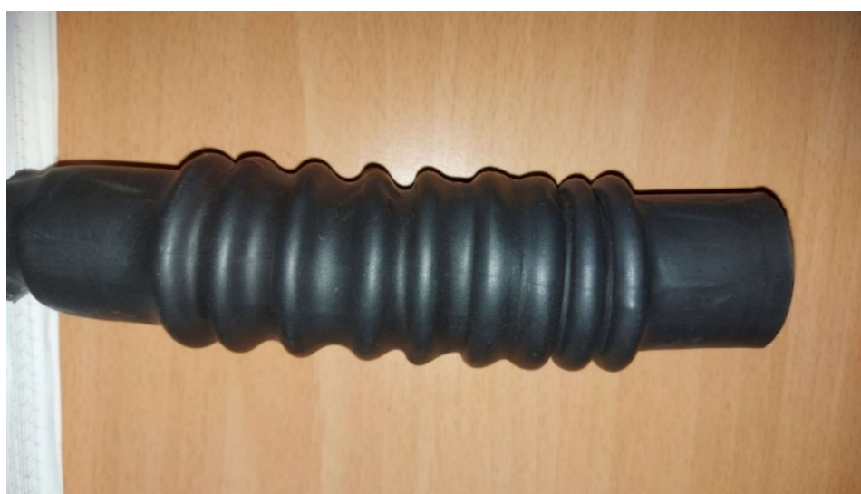
Slika 2.7. Druga iteracija ovojnice mišića
