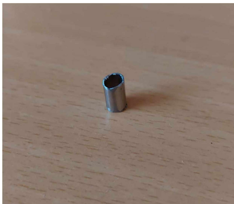
Slika 2.19. Komad metalne slamke korišten kao graničnik
