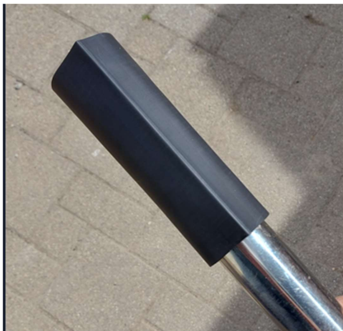
Slika 2.4. Termo-deformabilna polimerna cijev na kalupu prije grijanja
