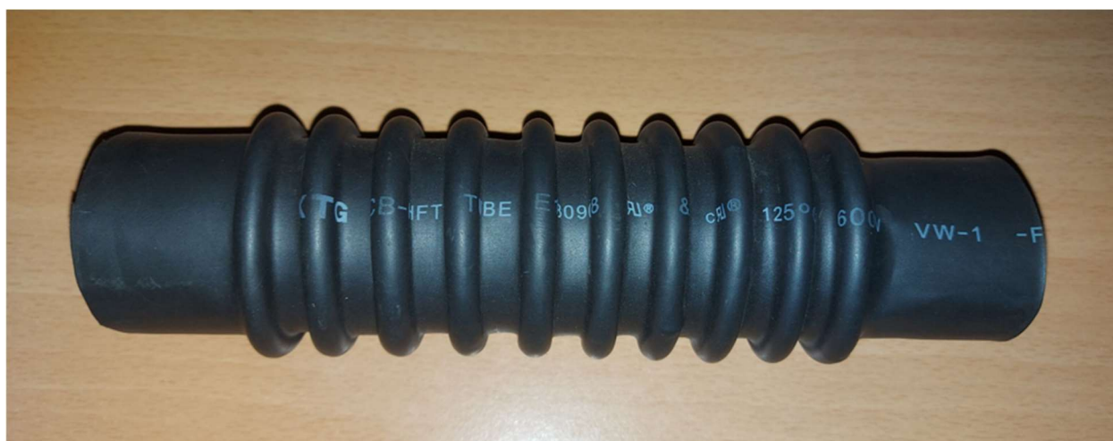
Slika 2.9. Treća iteracija ovojnice mišića
