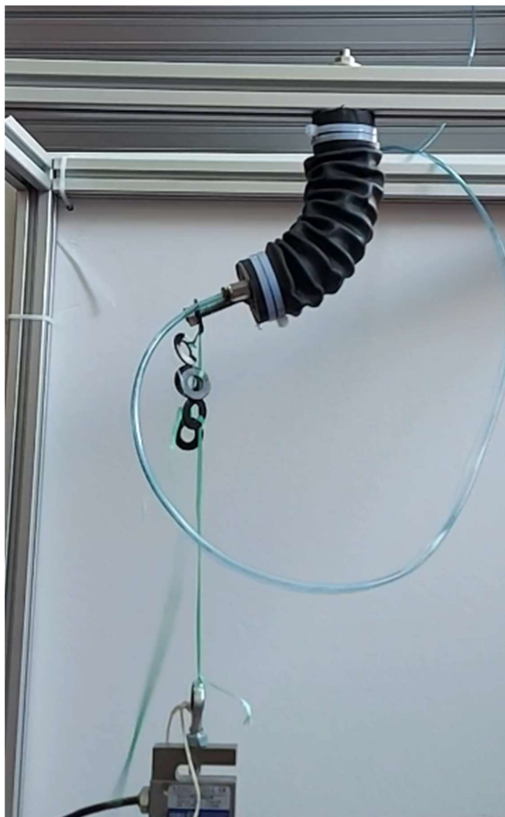
Slika 4.19. Mišić 3 povezan na senzor sile
