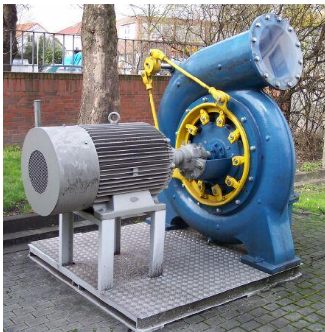
Slika 2.14. Hidrogenerator postavljen horizontalno s osovinom [3]
