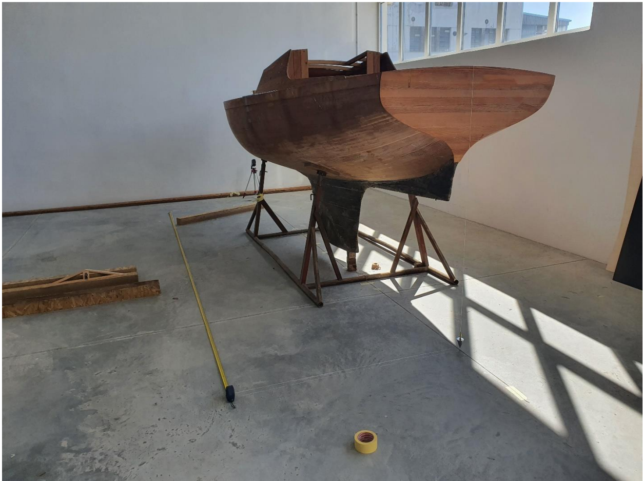
Slika 3.2 Mjerni instrumenti kod klasične metode snimanja forme broskog trupa
