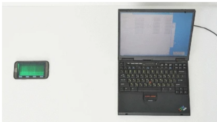
Slika 2.1 Snimanje zvukova iz ventilacijskih otvora prijenosnog računala koristeći pametni telefon ( Acoustic Cryptanalysis - Daniel Genkin, Adi Shamir i Eran Tromer [1])
