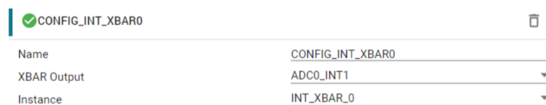
Slika 6.7. Povezivanje signala na sabirnicu XBAR
