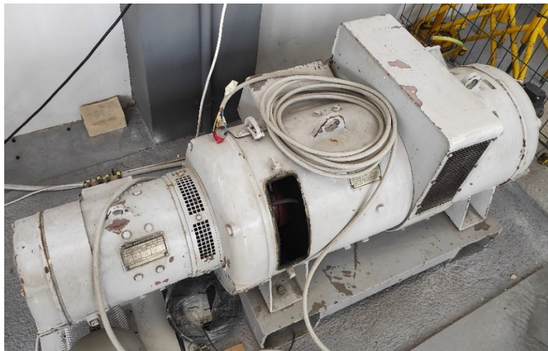
Slika 4.5. Laboratorijski asinkroni stroj 26kW
