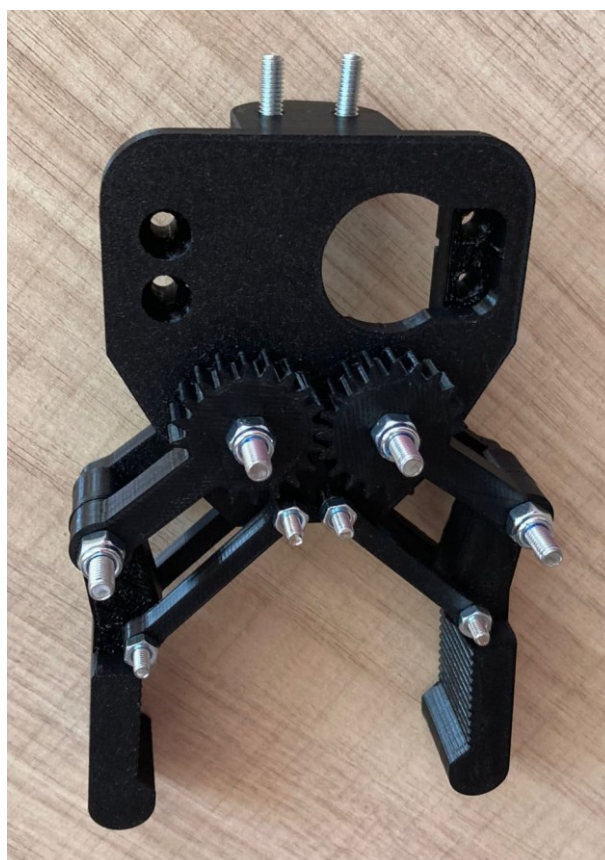
Slika 6.14-Hvataljka prije montaže na ruku 3
