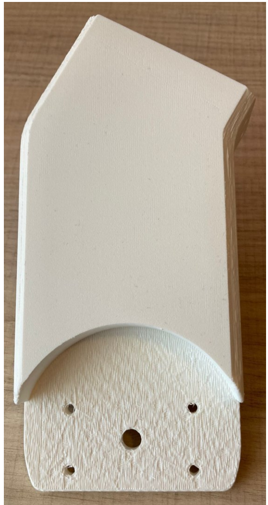
Slika 6.2-Ispisani dio s uklonjenim potporama
