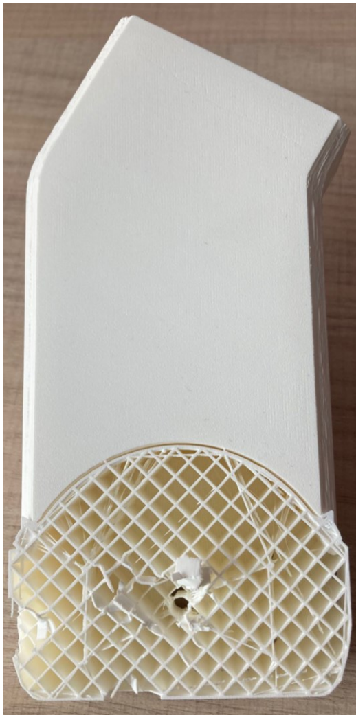
Slika 6.1-Ispisani dio s potporama
