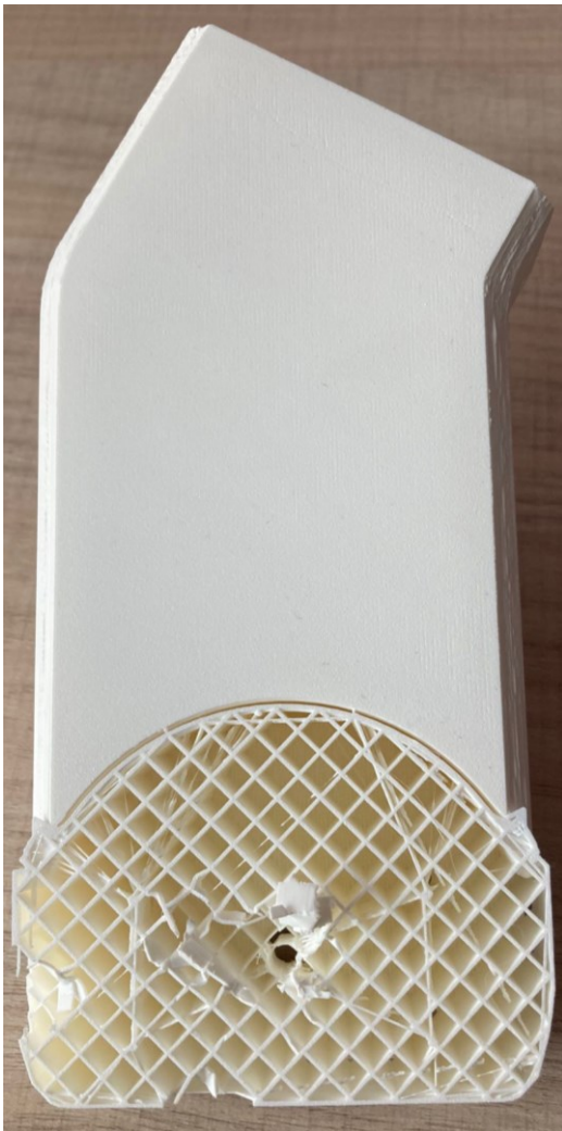
Slika 6.1-Ispisani dio s potporama
