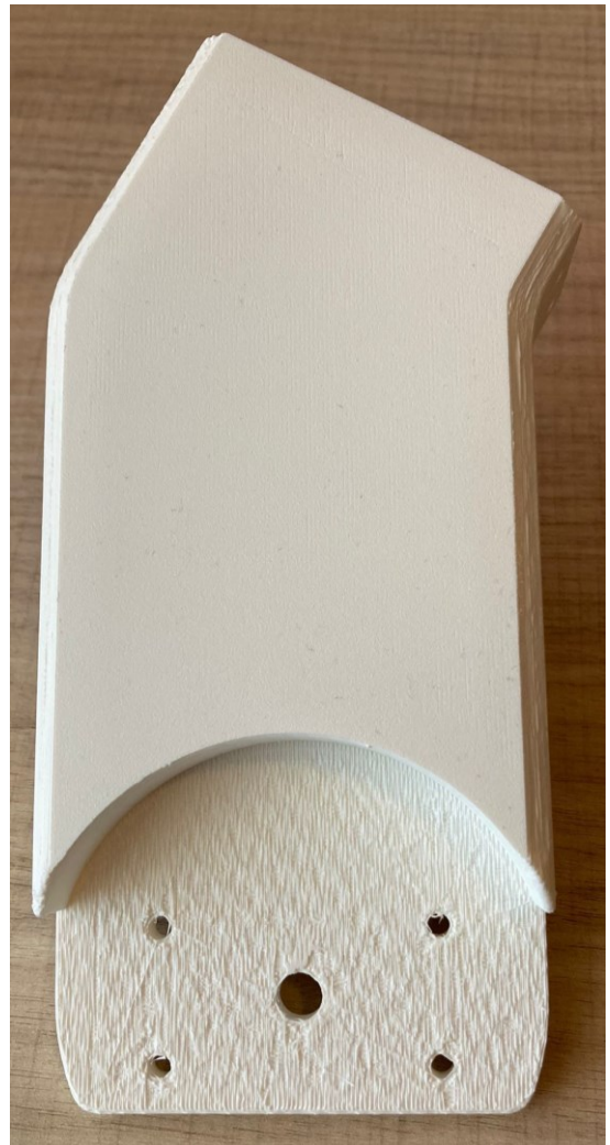
Slika 6.2-Ispisani dio s uklonjenim potporama
