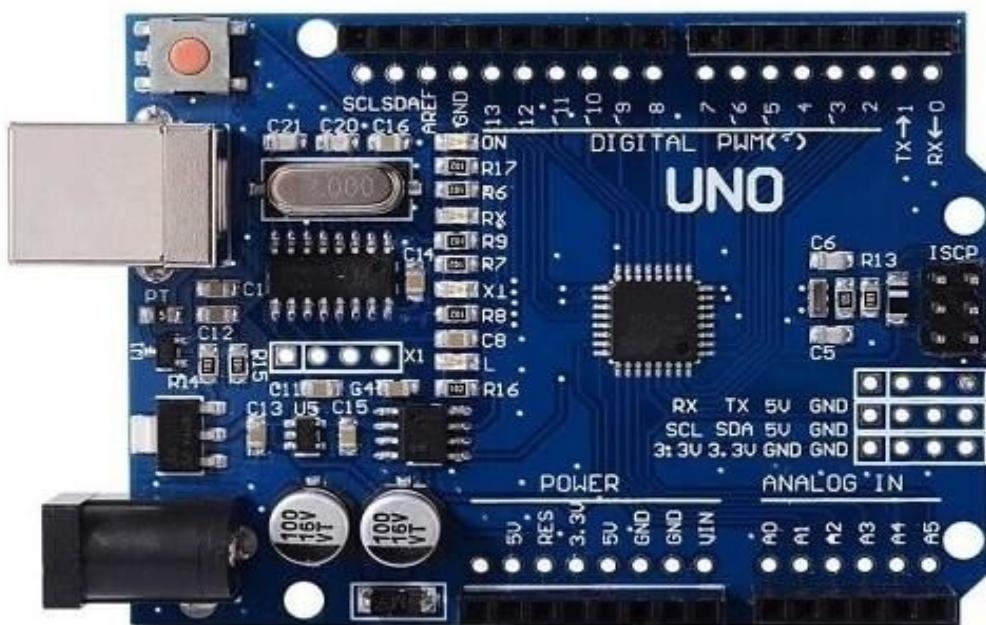
*Slika 3.1. Prikaz Arduino pločice[1].*
