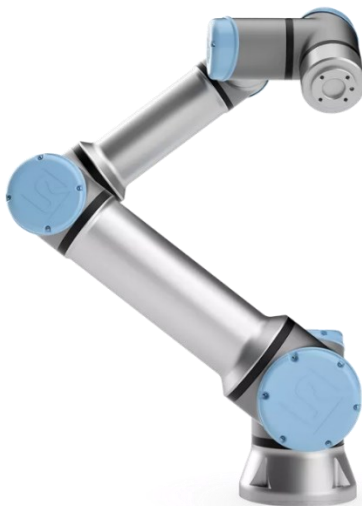
Slika 2.1. Primjer konstrukcije robotske ruke [12].
