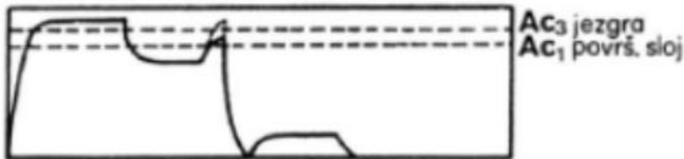
Slika 3.15. Postupka jednostrukog kaljenja nakon izotermičke pretvorbe
