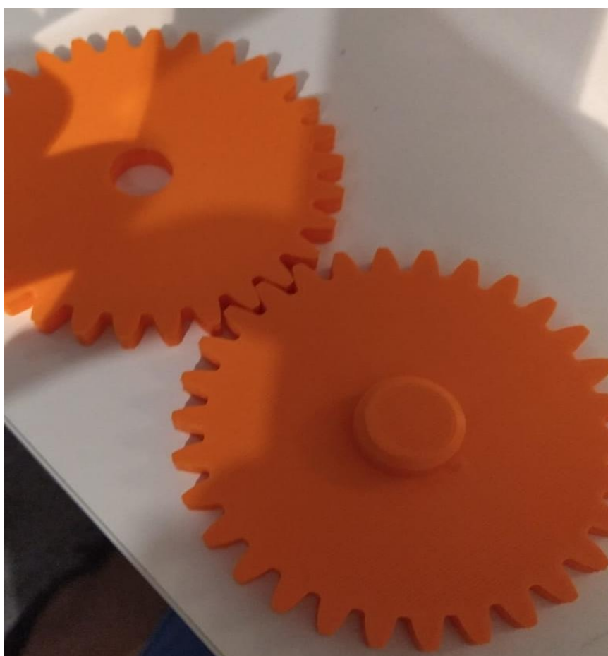
Slika 5.6. Isprintani zupčanici u zahvatu
