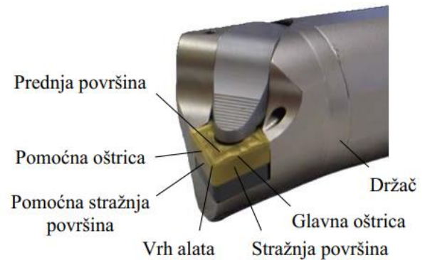
Slika 2.1.2. Rezni klin alata, površine i oštrice alata [1].
