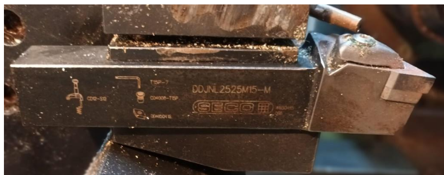
Slika 6.2.1.2. Držač rezne pločice SECO DDJNL 2525M15-M.
