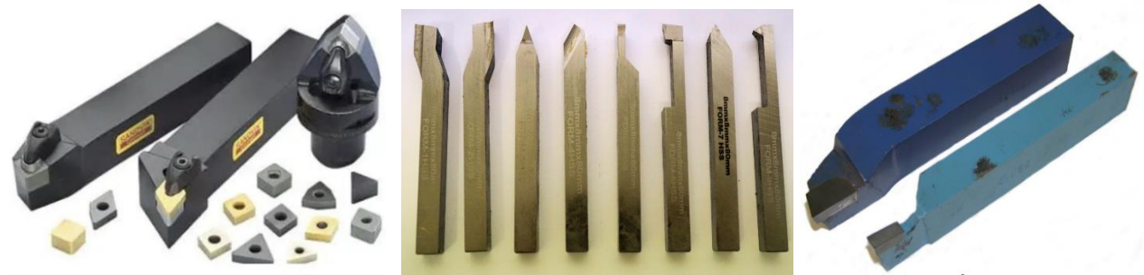
Slika 2.1.1. Tokarski alat s mehanički pričvršćenom reznom pločicom (lijevo), od brzoreznog čelika (sredina) i sa zalemljenom reznom pločicom (desno) [3].
