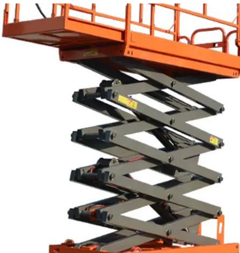
Slika 9. Višestruki škarasti mehanizam
