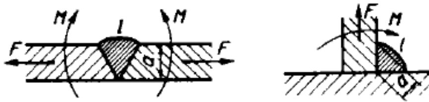
Slika 33. Djelovanje sile i momenta na zavarene spojeve
