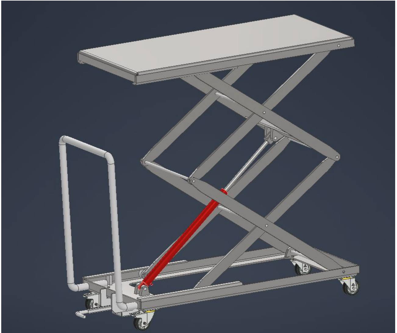
Slika 42. Sklop ručnih kolica s podiznom platformom
