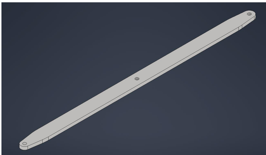
Slika 35. Nosač škarastog mehanizma (1/8)
