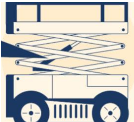
Slika 16. Skupljeni škarasti mehanizam
