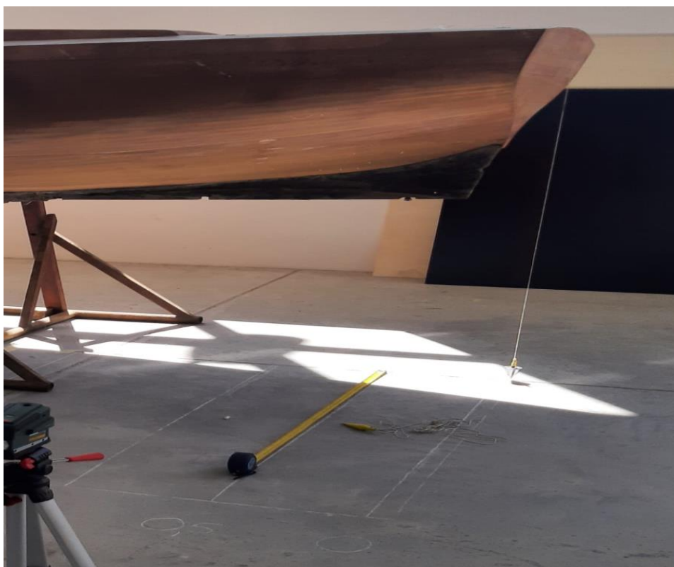
Slika 3.5 Upotreba alata za mjerenje točaka
