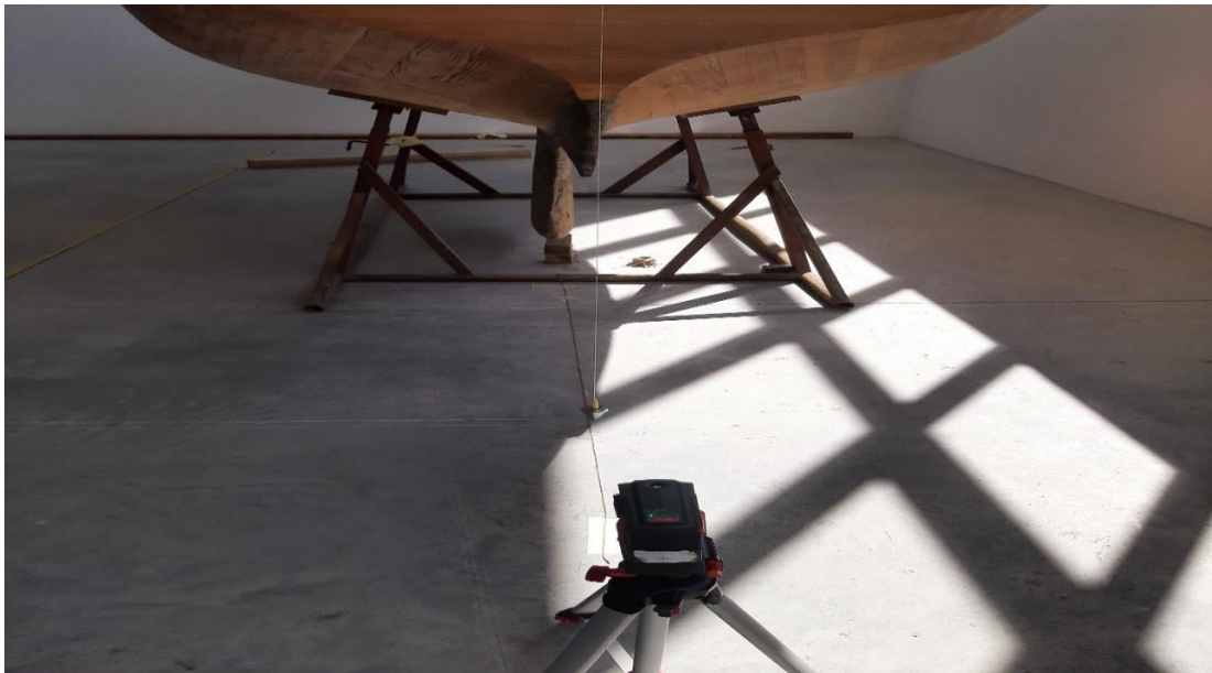
Slika 3.3 Postupak određivanja sredine jedrilice po širini
