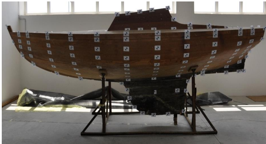
Slika 6.3 Naljepnice na karakterističnim točkama jedrilice
