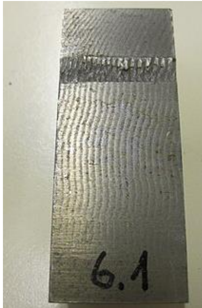
Slika 15 valovita strukutra nakon ekslozijskog zavarivanja
