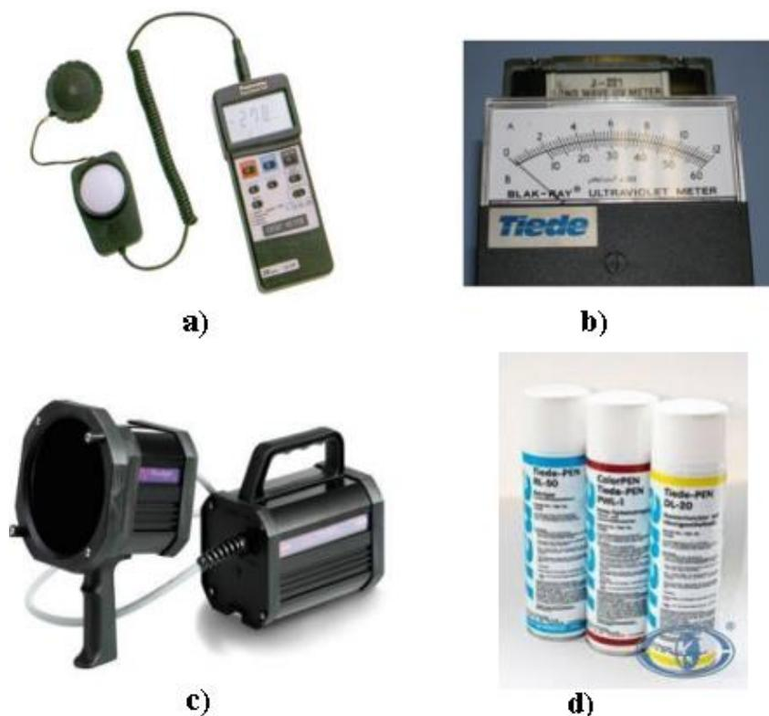
Slika 3.3. Oprema i pribor za ispitivanje tekućim penetrantima [5]
