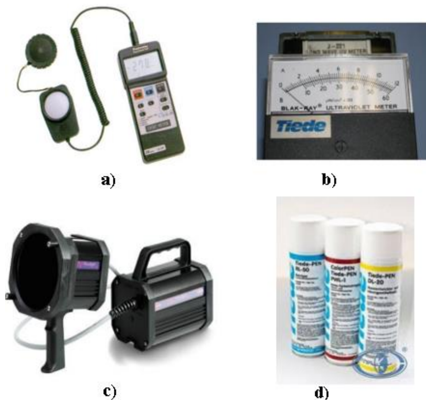
Slika 3.3. Oprema i pribor za ispitivanje tekućim penetrantima [5]
