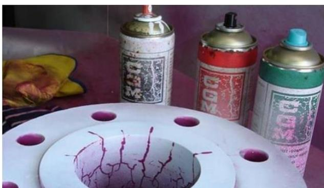
Slika 3.1. Ispitivanje tekućim penetrantima [5]
