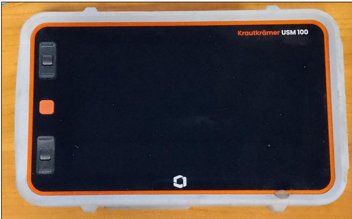
*Slika 7.2. Ultrazvučni uređaj USM 100*
