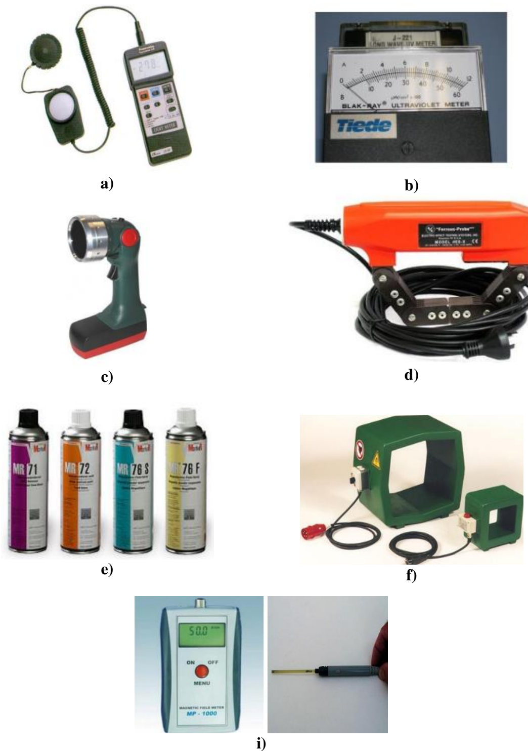
Slika 4.16. Oprema i pribor za ispitivanje magnetskim česticama [5]
