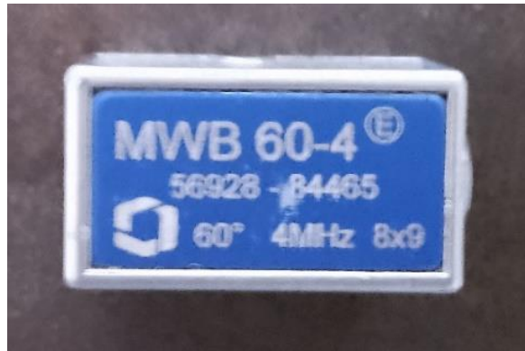
Slika 7.3. Kutna sonda MWB 60-4
