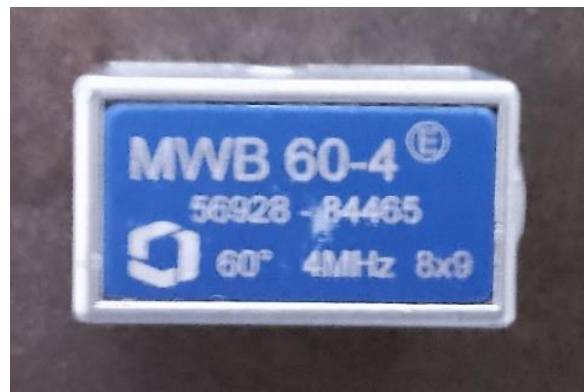
Slika 7.3. Kutna sonda MWB 60-4
