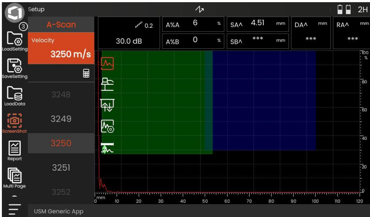
Slika 7.5. Odabir brzine ultrazvuka
