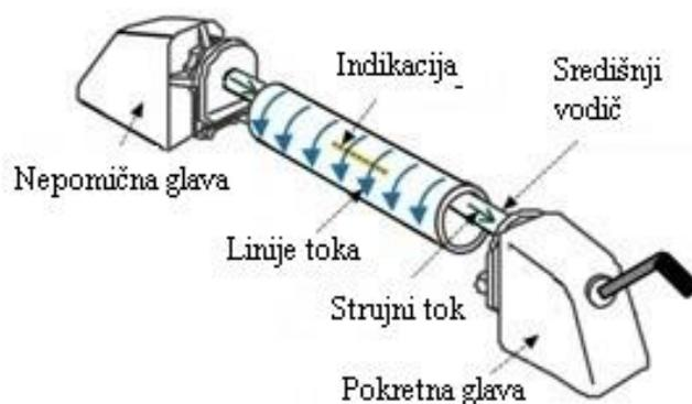
Slika 4.9. Kružna magnetizacija propuštanjem struje [13]
