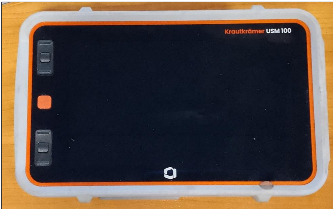
Slika 7.2. Ultrazvučni uređaj USM 100
