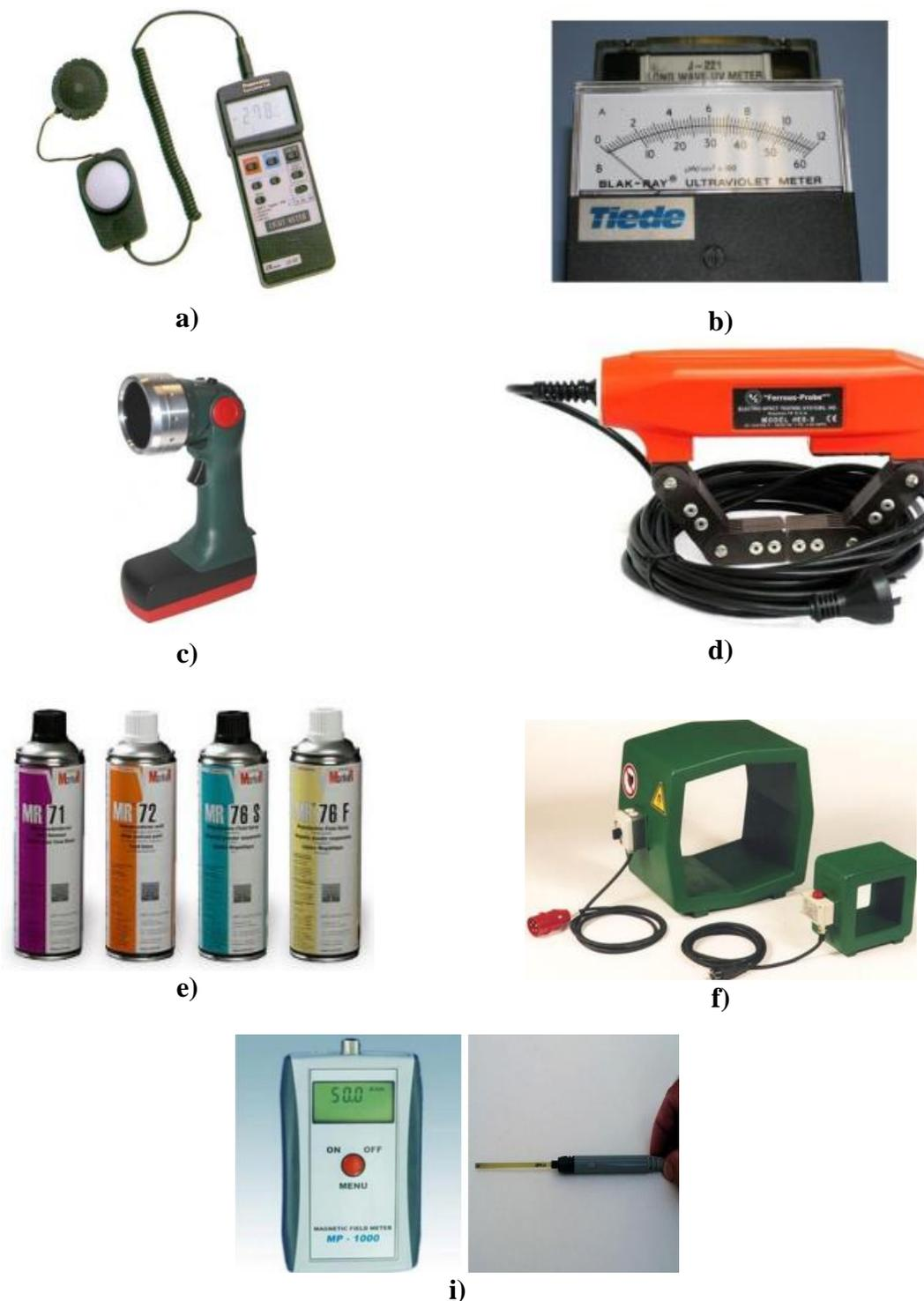
Slika 4.16. Oprema i pribor za ispitivanje magnetskim česticama [5]
