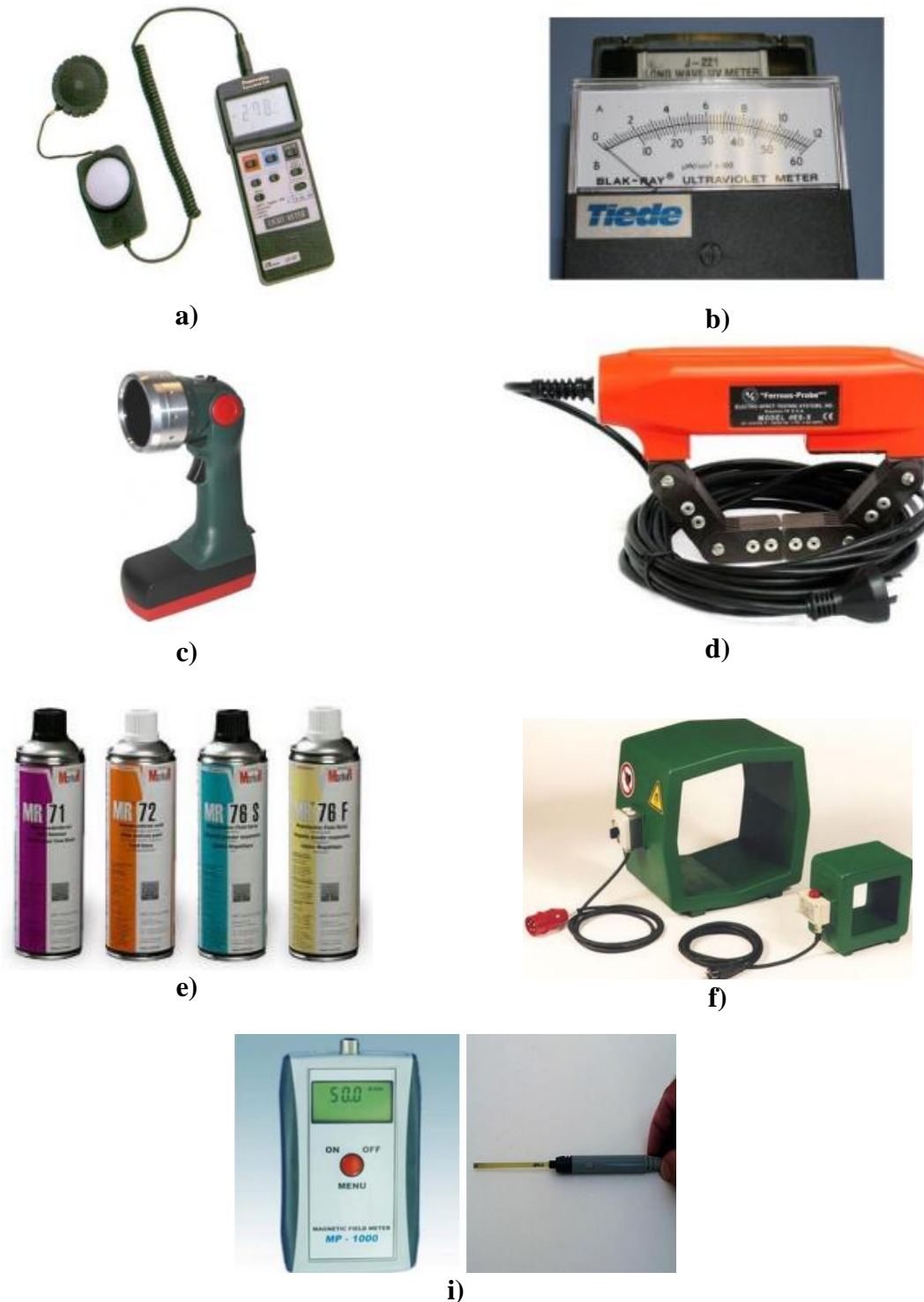
Slika 4.16. Oprema i pribor za ispitivanje magnetskim česticama [5]
