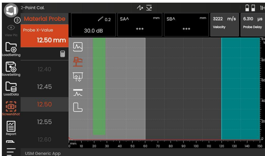
Slika 7.16. Odabir vrijednosti izlazne točke sonde
