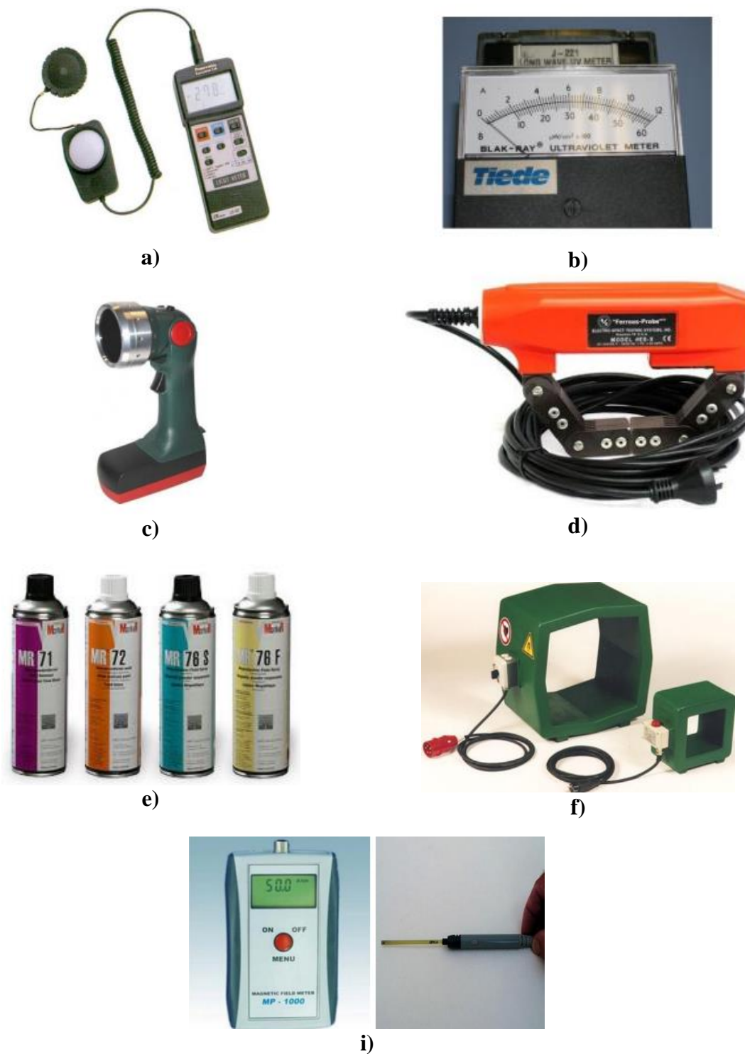
Slika 4.16. Oprema i pribor za ispitivanje magnetskim česticama [5]
