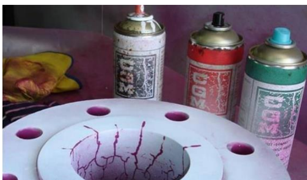
Slika 3.1. Ispitivanje tekućim penetrantima [5]
