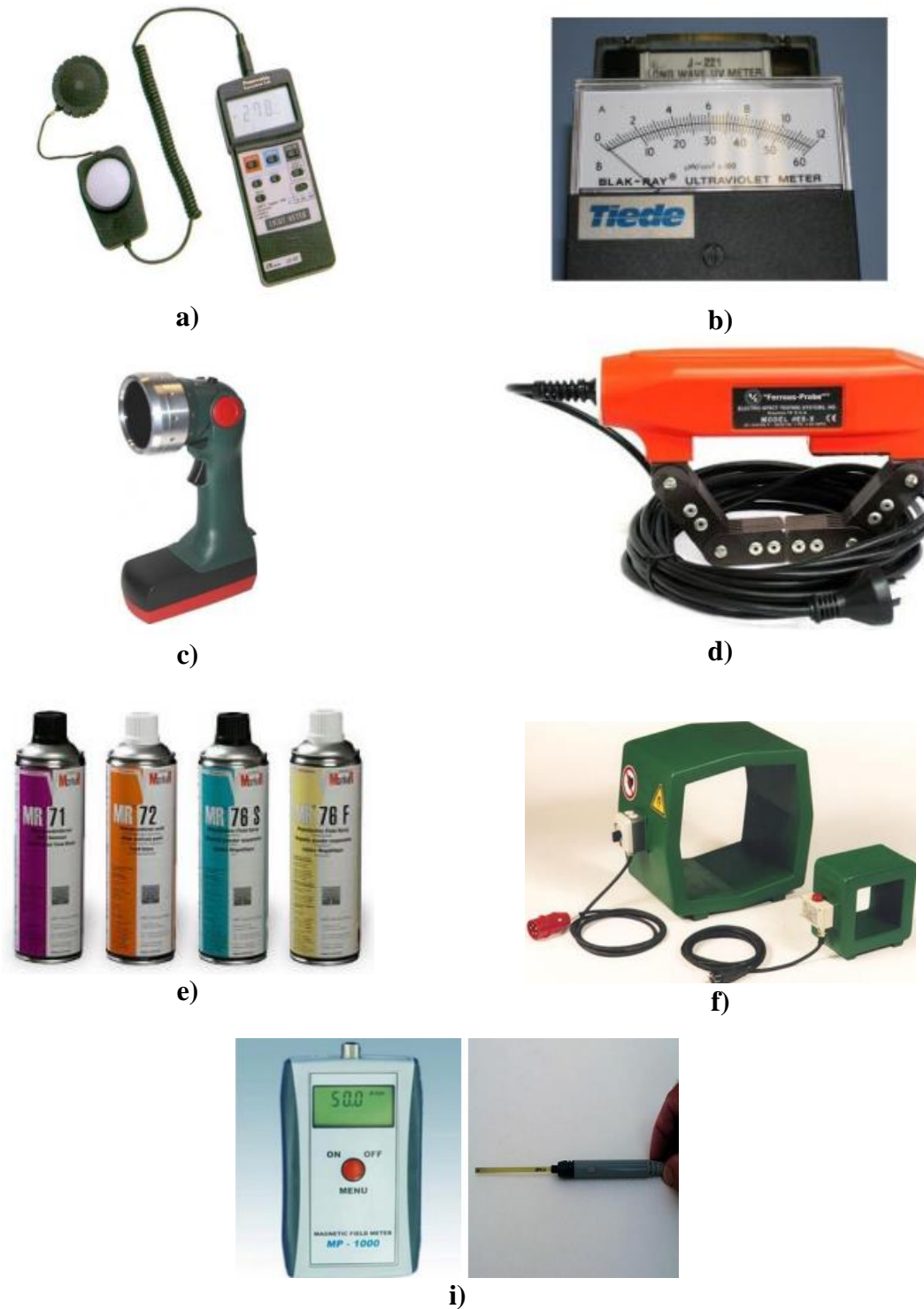
Slika 4.16. Oprema i pribor za ispitivanje magnetskim česticama [5]
