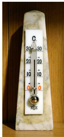
*Slika 2.2. Živin stakleni termometar za mjerjenje sobne temperature. Izvor: [4]*
