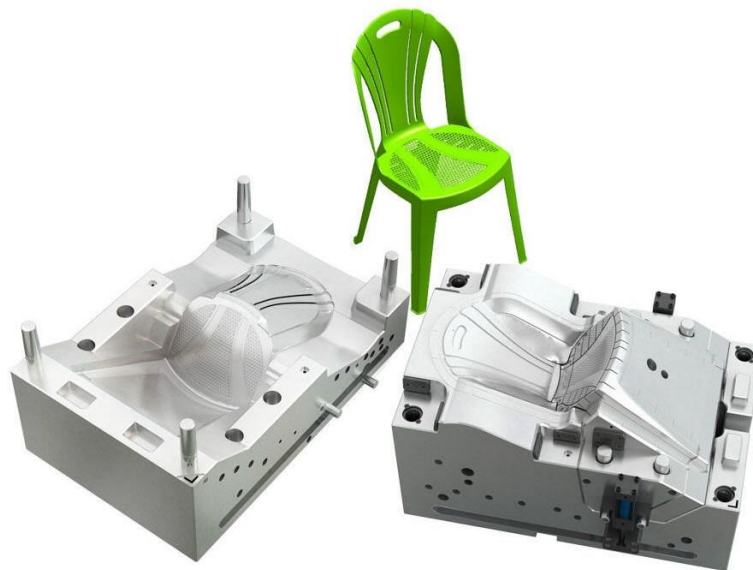
Slika 6.3. Kalup za izradu stolca iz polimera
