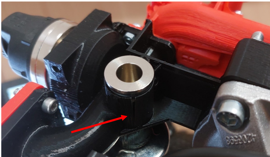
Slika 5.34. Lom prilikom montaže dijelova
