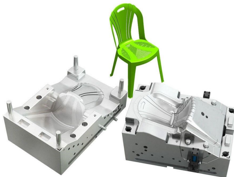
Slika 6.3. Kalup za izradu stolca iz polimera
