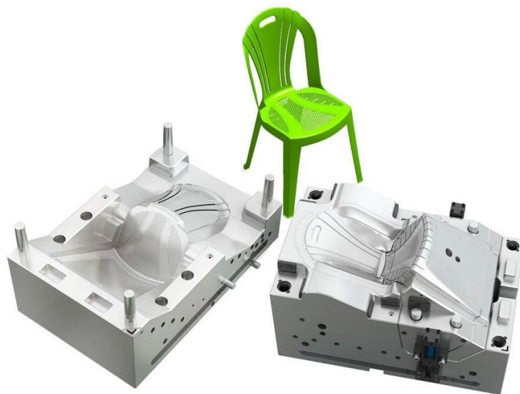
Slika 6.3. Kalup za izradu stolca iz polimera
